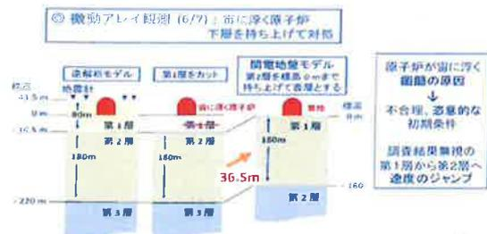
赤松先生が指摘した地盤モデルの問題の第一は、上図に示すとおり原発最下部からは厚さ36.5mの低速度層（軟らかい地盤）があるにもかかわらず、調査で第2層として整理した岩盤上に原発を設置しているとしたことであり、調査結果無視と地震波の増幅率を小さくすることにつながっていたとした。
