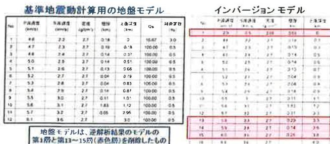
上の左側の表は標準地震動計算用の地盤モデル（関電モデル）であるが、右側の観測記録の逆解析結果（インバージョンモデル）を次のように変更している。
