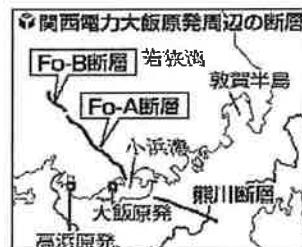
関電はこれまで、大飯原発北側の若狭湾海底を通る「Fo-A断層」(長さ23キロ・メートル)と「Fo-B断層」(同12キロ・メートル)の連動を考慮し、マグニチュード7・4の地震が起きると想定、大飯3、4号機の耐性検査では、最大の揺れ(700?)の1・8倍まで原子炉内の核燃料が損傷せずに耐えられると評価した。
