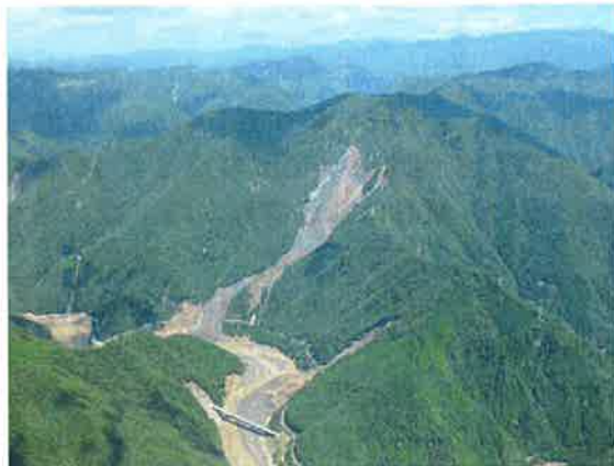
写真-3 奈良県十津川村宇宮原地区で発生した深層崩壊と土石流 (2011年9月発生) 人的被害なし(長殿発電所が被災) 提供:(独)土木研究所
