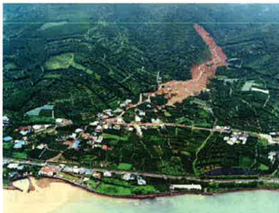
写真-1 鹿児島県出水市針原川における深層崩壊と土石流（1997年7月発生） 土砂量約 20 万 m 3 死者 21 名、負傷者 13 名、 全壊家屋 23 棟 提供：国土交通省
