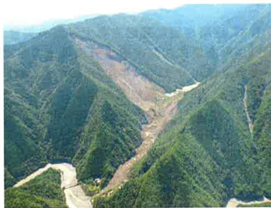
写真-4 奈良県五條市赤谷地区における深層崩壊と天然ダム (2011年9月発生) 土砂量約900万m 3 人的被害なし 提供:(独)土木研究所
