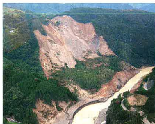
写真-2 宮崎県臼杵郡美郷町野々尾、耳川における深層崩壊と天然ダム（2005年9月発生） 土砂量約 1000 万 m 3 人的被害なし 提供：国土交通省
