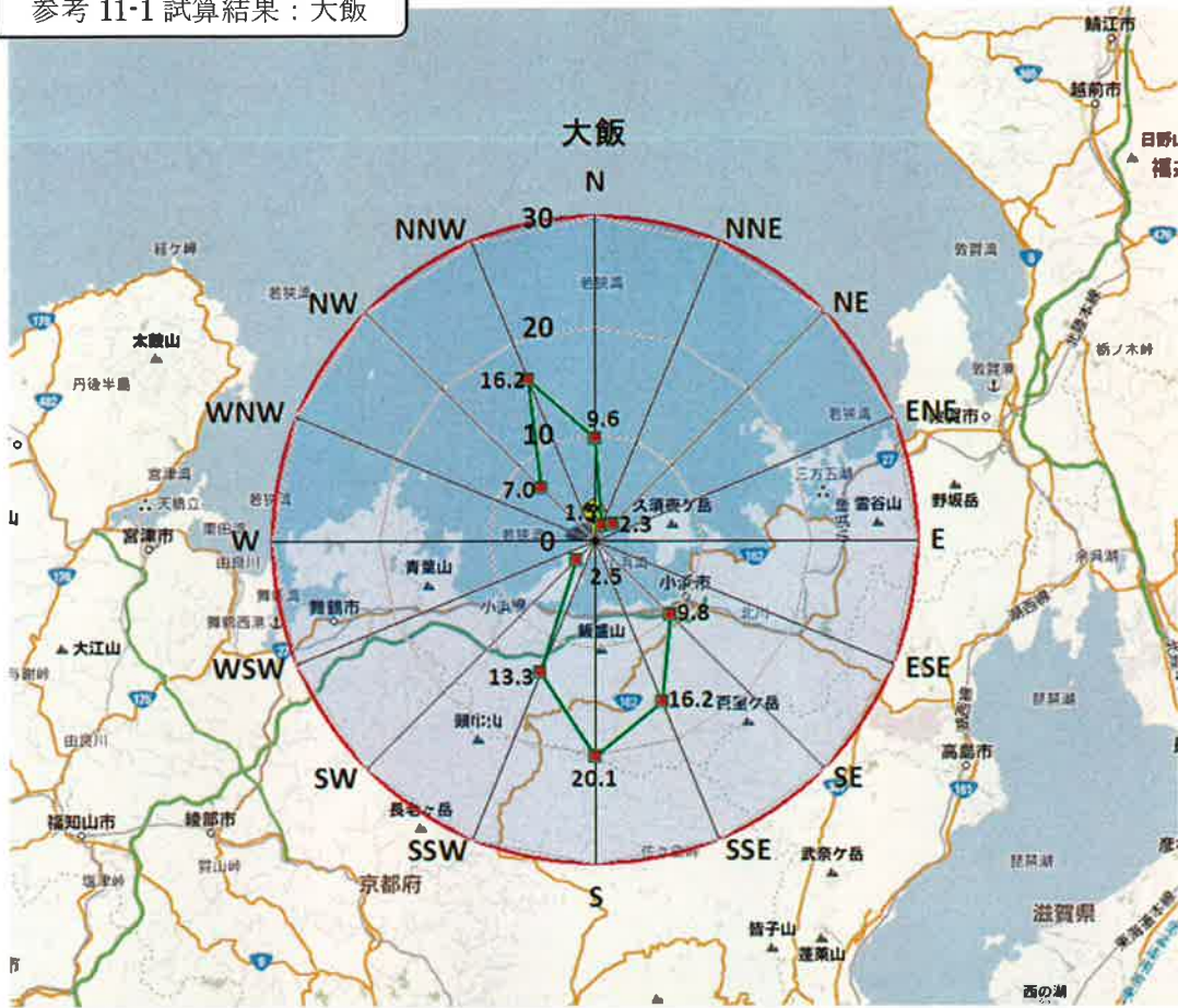
福島第一原子力発電所（1～3号機）の放射性物質量と同じと仮定した計算
