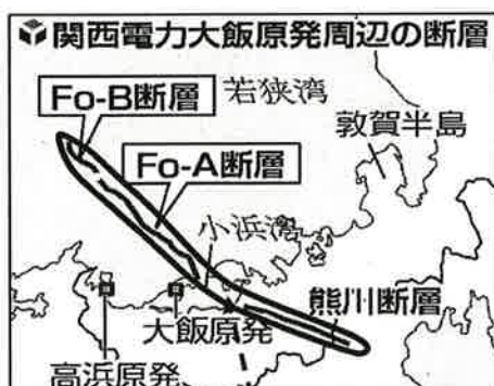
関西電力大飯原発周辺の断層 関電は、海底にある2本の活断層（Fo-B断層とFo-A断層）による約35kmの連動は評価しているが、内陸の熊川断層も含めた60km以上の連動を否定している (2012年1月28日付 読売新聞の図に加筆)
